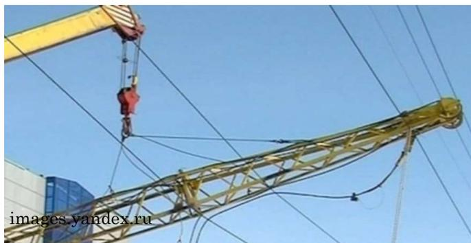
**В охранной зоне ЛЭП нельзя проводить погрузочно-разгрузочные работы. Задевание электрического провода грузовой техникой влечет несчастный случай с летальным исходом для человека!**
